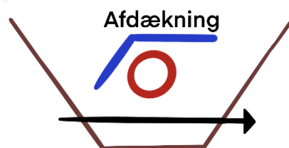
Figur 3: Kan der ikke skydes væk fra kablet graves prøvehul, hvor kablet identificeres og afskærmes.
