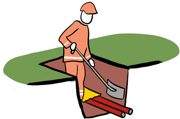
Figur 1: Grav forsigtigt ned til kablet. Håndskovl anbefales. Dækplast kan ligge meget tæt på kablet.
