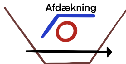
Figur 3: Kan der ikke skydes væk fra kablet graves prøvehul hvor kablet identificeres og afskærms
